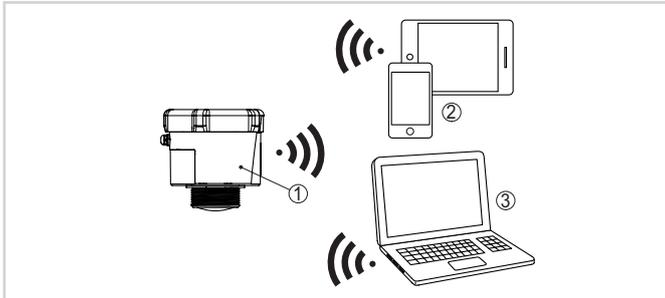
Connexion sans fil aux appareils de réglage standard par Bluetooth
