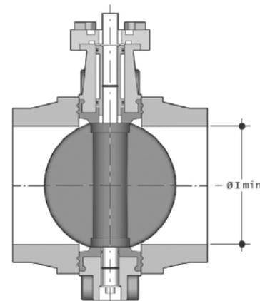
**I min** : diamètre minimum de la face du collet.
