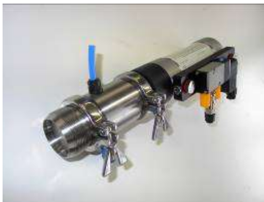
Piston de prélèvement sur conduite
