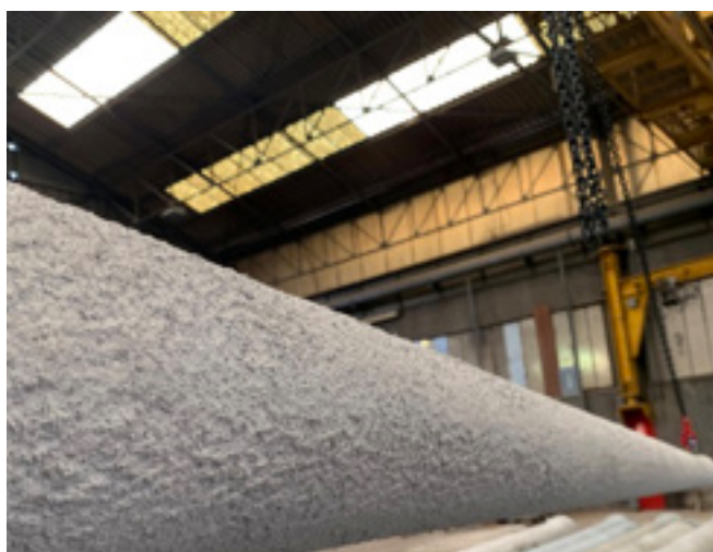
Canalisation avec un revêtement anti corrosion et friendly green
