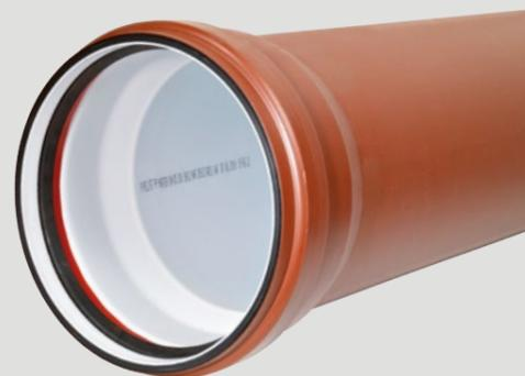
Lors du passage caméra, la couleur blanche de la couche interne du tube facilite l'inspection vidéo. Le marquage est visible à l'intérieur du tube, ce qui évite l'extraction du tube pour en connaître la traçabilité (nom du fabricant, date de fabrication...)
