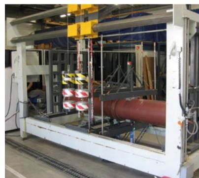
Banc d'essais vérifiant l'étanchéité des assemblages après écrasement et déviation angulaire
