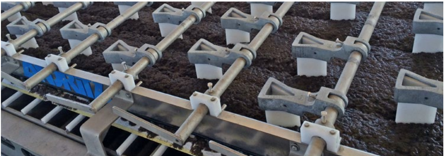
▲ Doigts de drainage optimisés pour une meilleure efficacité d'épaississement
