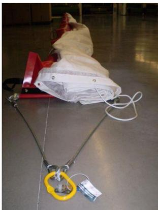
élément renforcé de fixation et traction
