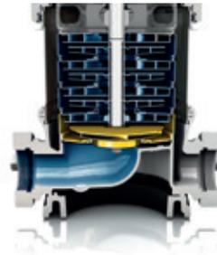
tec sans exiger de modifications du corps de pompe extérieur. Elle affiche un diamètre d'aspiration modifié, des aubes permettant un écoulement légèrement diagonal ainsi qu'un corps d'étage de conception nouvelle, ces caractéristiques permettant d'améliorer sensiblement la courbe NPSH de la pompe.
