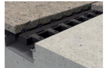
Connecto® Invisible dispose d'une fente de 8 mm respectant la "norme pieds nus", et affiche une classe de résistance A15 piétons (EN1433). Lorsqu'elle est utilisée en aménagement à l'intérieur des bâtiments ou à proximité immédiate, la grille s'avère également conforme à la classe L15 véhicules légers (NF 1253-4).
