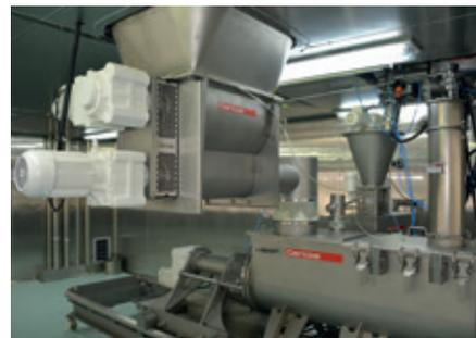
Les avantages de cette technologie sont multiples: un temps de séjour très court (environ 40 secondes), une qualité du mélange optimisée car aucun risque de ségrégation, une pulvérisation de liquide facilitée dans la zone de dosage à l'entrée du mélangeur, un faible encombrement de l'appareil.
