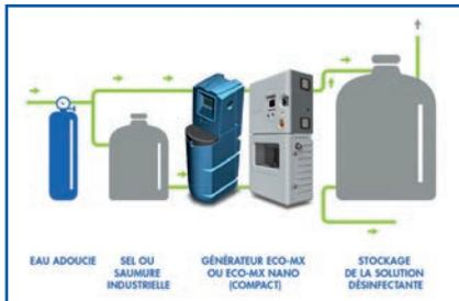
Au-delà du contrôle de la charge microbiologique, l'efficacité de l'ECO-MX nano permet de consommer moins de produit, de réduire considérablement les risques de corrosion et d'écartier celui de rejet de biocides organiques des installations. Son intégration sur les réseaux évite les manipulations et le stockage de produits chimiques dangereux pour la santé. La fabrication sur place du désinfectant entraîne la disparition des emballages et la réduction de l'impact de transport de 80 %.
