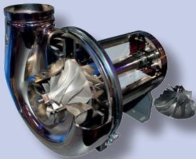
Les turbocompresseurs Aerzen sont des compresseurs de type centrifuge basse pression à très haut rendement destinés à la compression d'air totalement exempte d'huile. Le turbocompresseur se compose d'une ou deux turbines montées directement sur l'arbre moteur pourvu de roulements aérodynamiques sans contact. La grande vitesse de la turbine (jusqu'à 65 000 tr/mn) obtenue grâce au moteur synchrone à aimants permanents permet de délivrer 800 à
