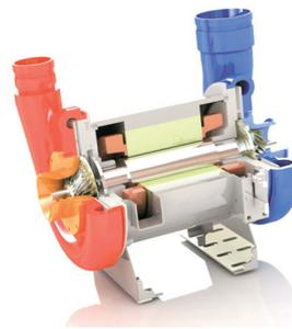
13200 m<sup>3</sup>/h d'air de 200 à 1200 mbars. Le turbocompresseur Aerzen intègre des technologies de pointe particulièrement fiables issues de l'industrie aéronautique. Conçus et intégrés par Aerzen, la turbine, le moteur synchrone à aimants permanents, les roulements aérodynamiques sans contact et le système de régulation par variation de vitesse sont la base des performances de ce turbocompresseur.
