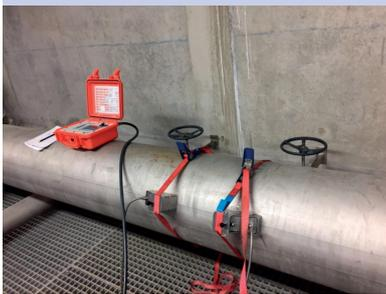
Le **SeFlow 400** est un débitmètre portable monovoie adapté aux applications de mesures de débits dans la distribution d'eau potable et sur les réseaux d'eaux usées, offrant stabilité et précision de mesure de débit bidirectionnelle à long terme. Ce débitmètre est idéal pour les activités de recherche de fuites d'eau grâce à sa capacité à mesurer de très faibles débits. Comme la mesure est effectuée de l'extérieur
