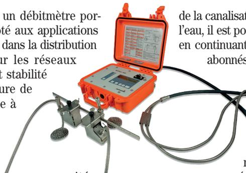
de la canalisation et sans contact avec l'eau, il est possible de faire la mesure en continuant de distribuer l'eau aux abonnés. La mesure est réalisée sans intrusion dans les canalisations. Ainsi, le **SeFlow 400** est l'outil idéal pour les activités de service et de maintenance, pour la vérification de compteurs/débitmètres existants et/ou un enregistrement des données à court ou long terme.
