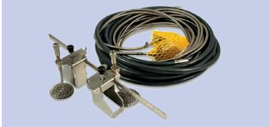
Des sondes à ultrasons sont mises en place sur la conduite. La distance entre les capteurs est déterminée par l'électronique en fonction des données d'entrée (diamètre, épaisseur, matériau de conduite, fluide à mesurer). Pour la mesure de débit, une impulsion ultrasonique est émise dans le sens de l'écoulement et une autre en sens inverse. Les capteurs
