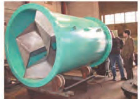
Mélangeur statique DN15 à DN3000 en tuyauteries ou canaux ouverts
