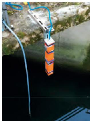
Le système est composé d'une LED UV pulsée, d'un récepteur et d'un ensemble électronique pour le contrôle et le traitement des données.
