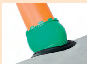
Awadock New Generation pour piquage DN/OD 160 et 200 sur collecteur grès ou béton d'épaisseur 37 à 175 mm.
