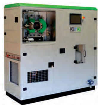
La machine DFD-MC 4.1 dégraisse plusieurs milliers de micro-pièces en polymère de moins de 3 mm de diamètre, en les exposant à une atmosphère de CO 2 dans son domaine supercritique, complétée d'oscillations et d'ultrasons.
