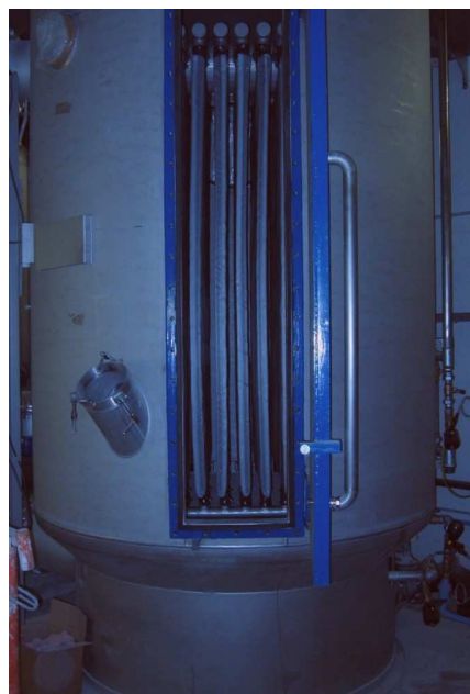
Les plateaux du 88M visibles de l'extérieur
