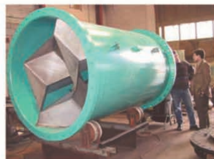
Mélangeur statique DN15 à DN300 en tuyauteries ou canaux ouverts
