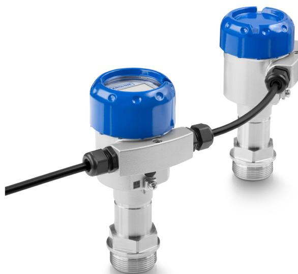
au transmetteur MAÎTRE qui mesure la pression relative en bas du réservoir et calcule la différence de pression. Cette configuration permet des économies de coûts et une durée d'installation réduite. Le transmetteur eDP peut être configuré avec des membranes de process métalliques ou en céramique.
