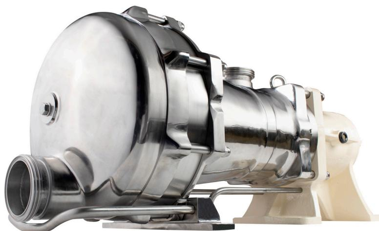
La série H-FLO est une pompe volumétrique à piston excentré sans joint d'étanchéité conçue pour répondre aux normes sanitaires des process industriels. Elle est livrée sur un socle et donc facile à installer. Par l'absence de garniture mécanique, de pignons de synchronisation, de bagues ou d'aimants, elle nécessite peu de maintenance et donc moins de périodes d'arrêts dans le process.
