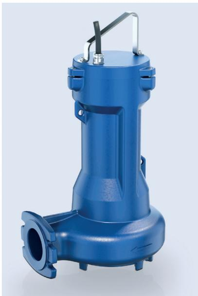
L'Amarex est une pompe submersible monocellulaire, monoflux, non auto-amorçant, en construction monobloc avec roue vortex. Elle vise le pompage de tous types d'eaux chargées et usées, notamment les eaux usées non dégrillées contenant des particules solides et des fibres longues. Elle est conforme à toutes les exigences de protection contre les explosions des règlements ATEX, FM et CSA.
