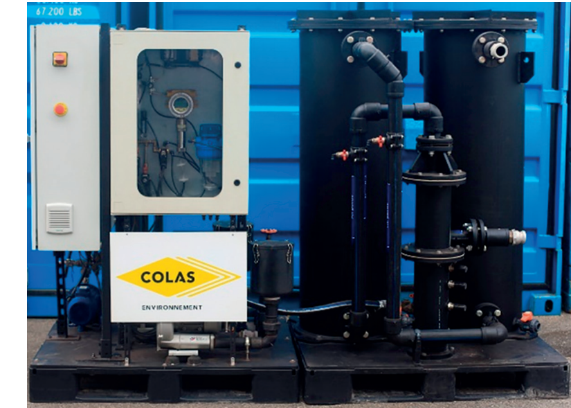
Figure 1 : Exemple d'un SKID de venting.
