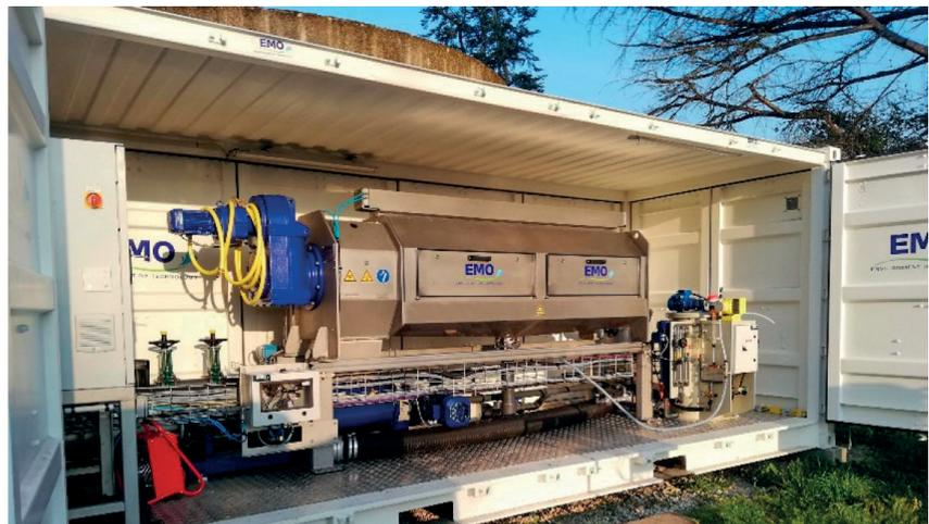
d'un combiné table d'égouttage/filtre à bandes, d'une pompe d'évacuation et d'un skid périphérique équipé d'une armoire de commande, d'une centrale de préparation de polymère, d'un ensemble alimentation des boues et d'un circuit d'eau de lavage.
