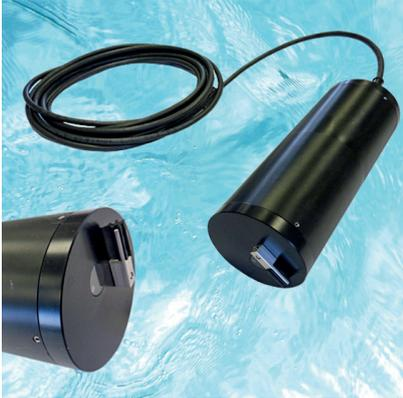
La sonde de turbidité à immersion **Turbi-probe 4000+** mesure de manière autonome la qualité des eaux chargées, des eaux usées avec effluents industriels et des eaux de rejet post-traitement. Elle mesure dans une large plage comprise entre 0 et 4.000 NTU avec une résolution de 0,01 NTU. La mesure est réalisée par néphélométrie suivant la norme ISO 7027.
