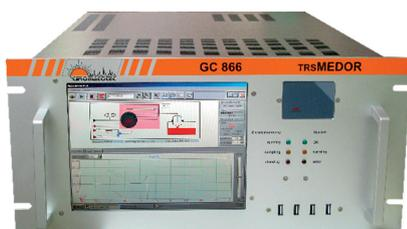
L'analyseur TRS MEDOR® de Chromatotec est un analyseur de gaz automatique et isotherme dédié à l'analyse des composés soufrés (H<sub>2</sub>S, Mercaptans et sulfures). Il existe en deux versions : quantification des composés en ppm et en ppb.
