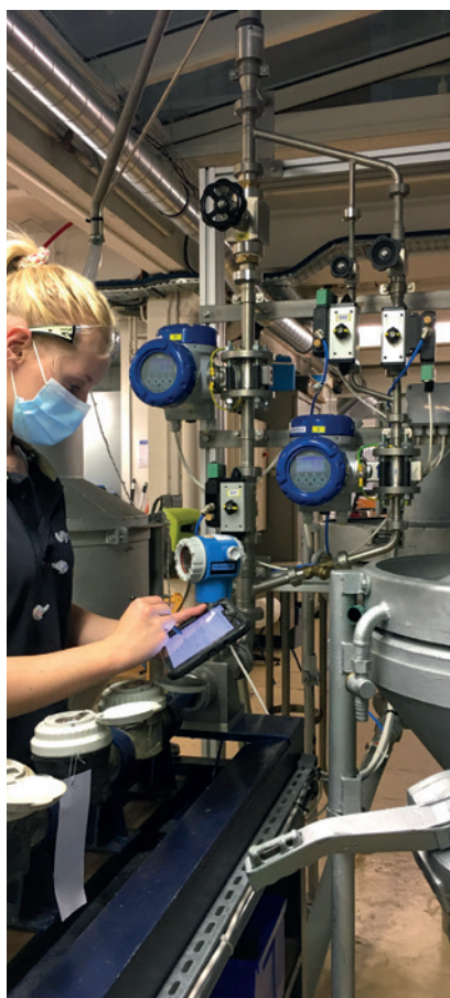
Etalonnages de compteurs venant du terrain pour étude de vieillissement.
