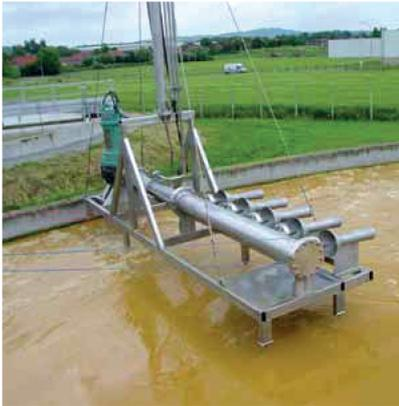
Le système Halia® Venturi Aeration System est conçu pour des besoins d'aération temporaires :
