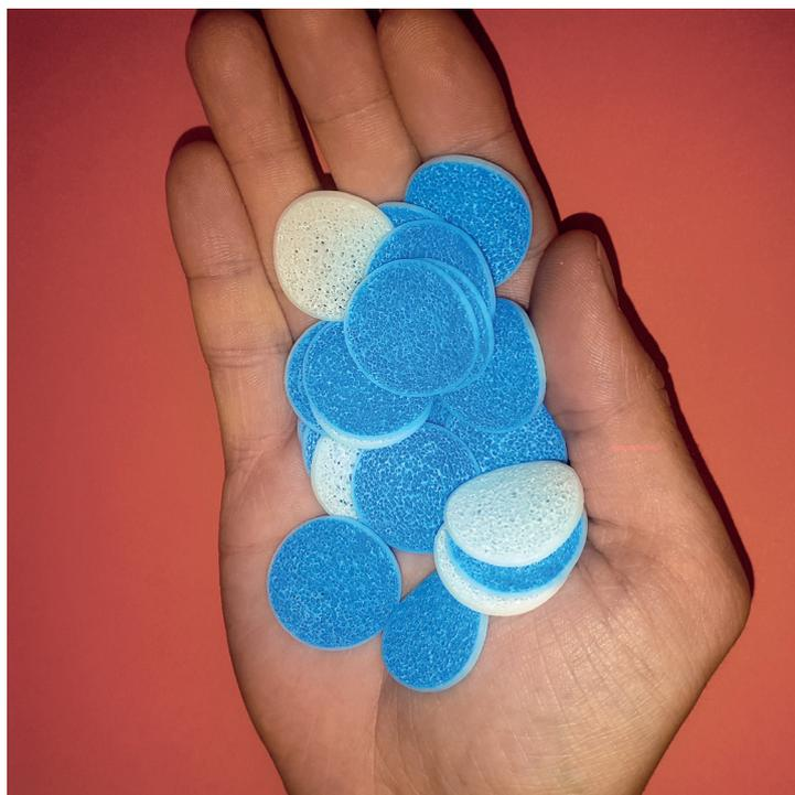
en substrat et en oxygène des deux côtés du support grâce à sa finesse. Les taux de dégradation restent constants et les processus biologiques s'en trouvent stabilisés.
