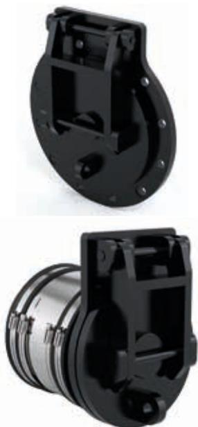
Fernco a développé une gamme de clapets de nez de haute qualité fabriqués en polyéthylène haute densité (PEHD). Deux types de clapets de nez, à bride ou à emboîtement, sont disponibles en version standard du DN100 au DN600. D'autres dimensions sont possibles, sur simple demande.
