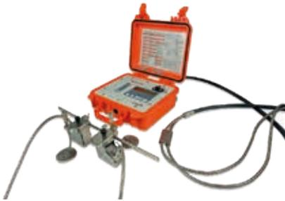
Le SeFlow 400 est un débitmètre portable monovoie adapté aux applications de mesures de débits dans la distribution d'eau potable et sur les réseaux d'eaux usées, offrant stabilité et précision de mesure de débit bidirectionnelle à long terme.
