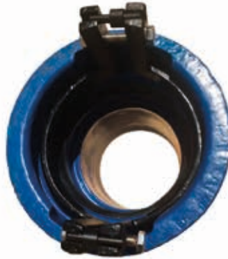
Étape 1: Installation du collier ELECTROLOCK® dans la deuxième chambre de l'emboîture, tandis que la bague de joint a été placée dans la première chambre d'étanchéité de l'emboîture.
