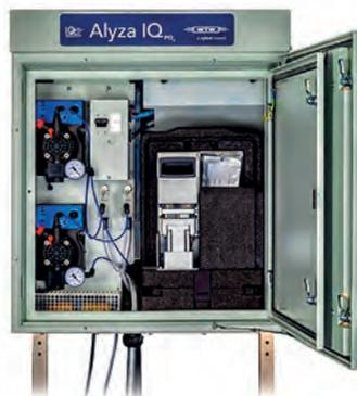
L'Alyza IQ PO<sub>4</sub> de Xylem Analytics est un nouvel analyseur d'orthophosphates utilisable directement en bord de bassin, reposant sur la méthode au vanadate de molybdate (méthode jaune). Il se caractérise par la fiabilité de ses résultats sur toute la gamme de mesure, et par une optimisation de la consommation, mais aussi des pertes, de réactifs. Avec une consommation réduite à 5 µL par échantillon, l'Alyza IQ ouvre la voie à une utilisation réduite de la chimie.
