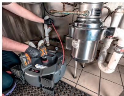
Les machines RIDGID® FlexShaft™ effectuent rapidement et efficacement le nettoyage d'un mur à l'autre de conduites résidentielles et commerciales d'un diamètre de 32 mm à 100 mm sur une longueur de 21,3 m.
