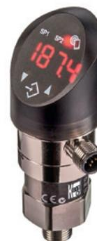
Le PSD de Kobold fait la synthèse entre les transmetteurs de pression, les manomètres digitaux et les pressostats. Il est en effet doté en standard d'un afficheur 4 digits orientable, d'une sortie analogique paramétrable en 4-20 mA ou 0-10 Vcc et de 2 sorties contact PNP. Avec sa précision typique de 0.5 % de l'échelle, son raccord fileté G1/4" inox, ses échelles entre -1 et + 600 bar, il peut répondre de façon économique à de très nombreuses applications.
