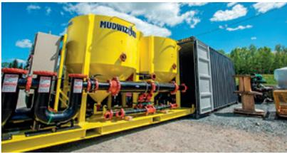
Mudwizard, développé par Technosub, une entreprise reconnue pour ses pompes et solutions industrielles de dénoyage, et présenté en France par CE2A Tsurumi, est un système de prétraitement des boues par décantation des eaux de chantiers et tunnels.
