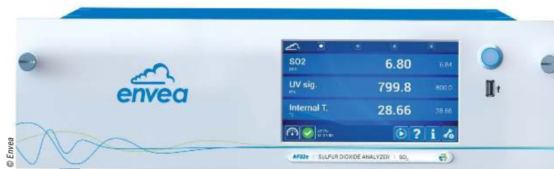
L'analyseur de dioxyde de soufre (SO 2 ) de la série E d'Envea utilise la fluorescence UV pour la surveillance du H 2 S et du TRS (soufre réduit total) dans une plage de mesure de 0-1 ou 0-10 ppm.
