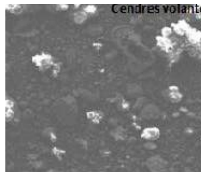
Figure 3: Morphologie des cendres de foyer par MEB.
