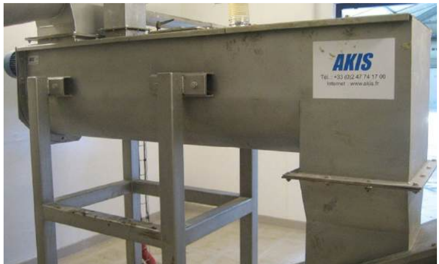
Les malaxeurs horizontaux (ici, un modèle installé sur site) et les malaxeurs verticaux d'Akis s'adaptent à toutes les installations de chaulage et à leurs contraintes d'organisation ou d'implantation.
