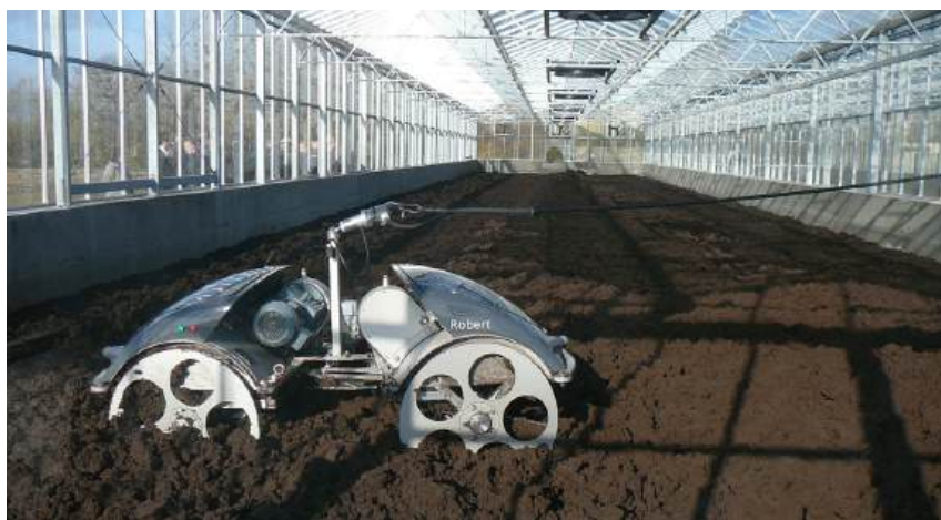
Le robot de brassage automatisé (ici, un sanglier électrique Robert dans le StorageDryer de Thermo-System) a été spécialement conçu pour le retournement et l'aération des boues au sein d'un sécheur solaire.
