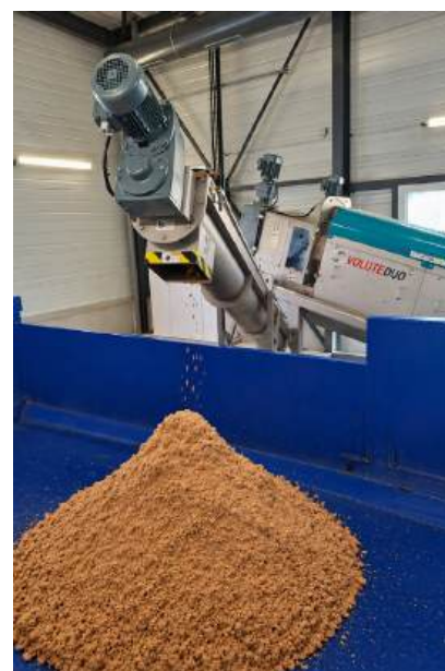
La presse de nouvelle génération Volute Duo RVP-601 d'Amcon Europe fournit, dans cette usine de cosmétiques, un gâteau d'une boue bio à 21 % de siccité.
