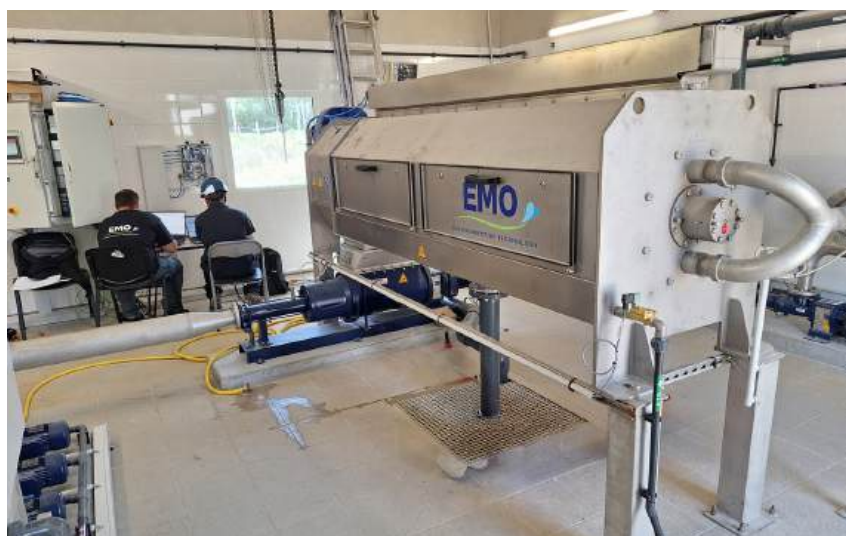
La presse à vis commercialisée par EMO France est utilisée pour la déshydratation de boues biologiques urbaines.
