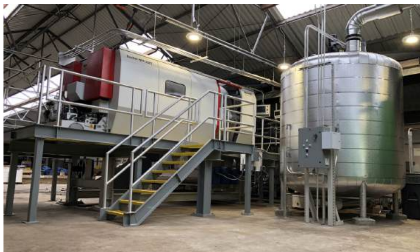
La presse à piston HPS de Bucher Unipektin est en mesure d'estimer, de manière précise et en continu, la siccité des boues dans la machine sans autre capteur supplémentaire.
