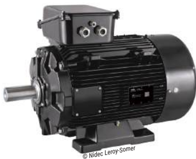
Nidec Leroy-Somer met en avant sa gamme Dyneo+, un moteur à réluctance assistée d'aimants, dont le rendement dépasse le niveau IE5 en combinant les atouts du synchrone et la robustesse mécanique de l'asynchrone.
