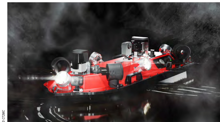
La gamme de drones flottants et roulants Can'Eau de CT2MC combine caméra sphérique, positionnement de classe A dans l'ouvrage et instrumentation complémentaire dédiée à la caractérisation fine des réseaux.
