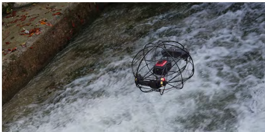
L'ASIO X de Flybotix permet de pénétrer dans un ouvrage avant toute intervention humaine et, grâce à un capteur multi-gaz, de restituer, en temps réel, l'atmosphère aux équipes restées en surface, qui peuvent alors décider des mesures à prendre.
