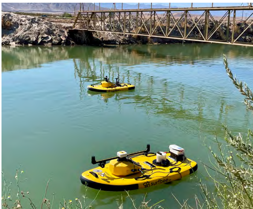
Les drones de surface Surfbbee de Xylem, liés à un capteur à effet Doppler, permettent de mesurer les niveaux et les débits en différents points, sans exposer l'opérateur à une zone difficile.
