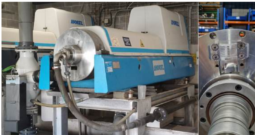
Parmi les solutions contribuant à l'efficacité énergétiques des stations d'épuration, Andritz propose des décanteuses centrifuges avec système Argos (à gauche) et des plaquettes de niveau TurboJet.
