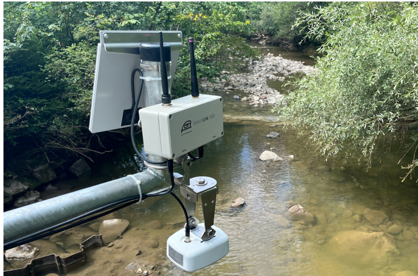
L'approche intégrée d'OTT France prend, notamment, la forme des stations radar OTT FMS regroupent capteurs, alimentation autonome et moyens de communication dans un équipement compact.
