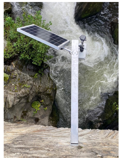
vorteX-io propose une station de mesure autonome et connectée, capable de mesurer simultanément plusieurs paramètres (hauteur d'eau, vitesse de surface, débit...).
