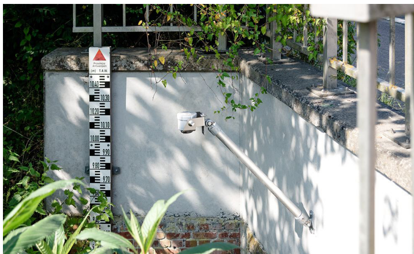
Les informations collectées par les capteurs (ici, un capteur de niveau radar Vegapuls Air de Vega) alimentent les outils d'aide à la décision utilisés par les collectivités. Mesurer un niveau, c'est transformer une donnée brute en capacité d'action.
