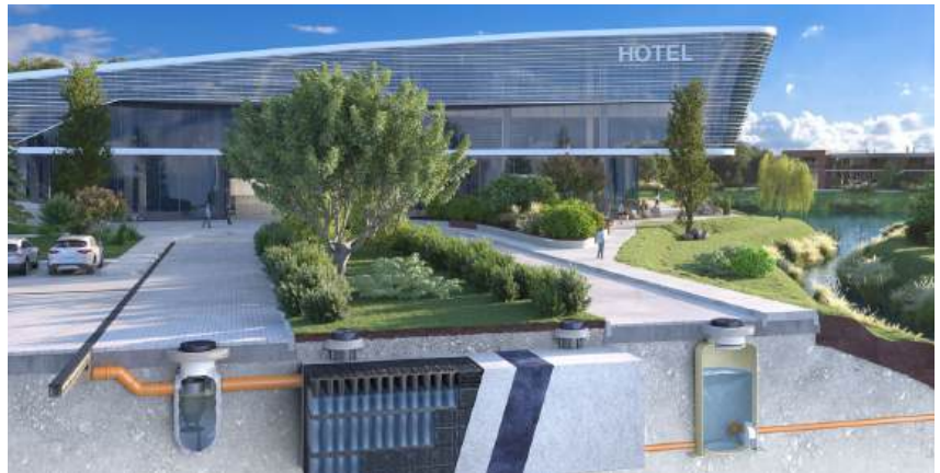
Il s'agit du détail d'une gestion intégrée des eaux pluviales avec collecte en surface, traitement des polluants et stockage temporaire avant rejet maîtrisé vers le milieu naturel.
