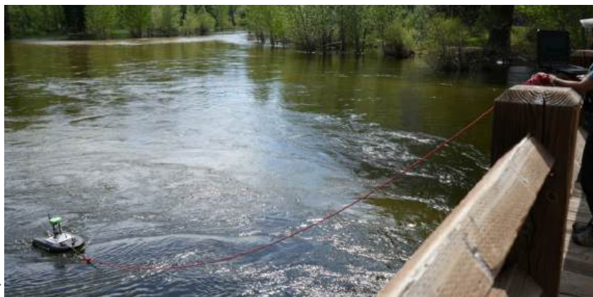
Avec sa marque SonTek, Xylem développe des solutions de mesure de niveau. En utilisant la technologie à effet Doppler, elles associent ces données au suivi des débits.
