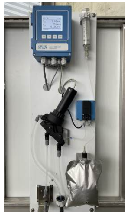
Swan Instruments d'analyse a profité de l'ajout de la nouvelle électronique pour accroître la facilité d'utilisation de son mesureur de turbidité AMI-II Turbisafe, via le module de nettoyage automatique Cleaning Module-III P.
