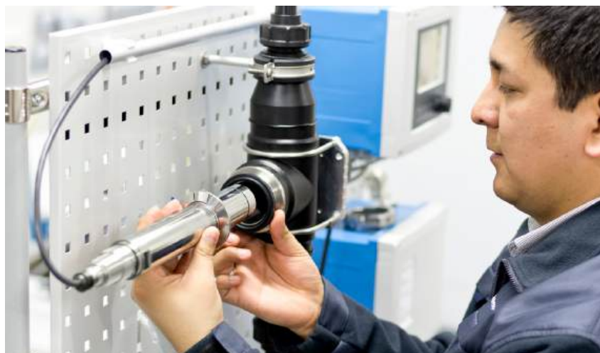
Un capteur de turbidité Turbimax CUS52D est en cours d'installation sur une platine clé en main d'Endress+Hauser, destinée à une application d'eau potable.
