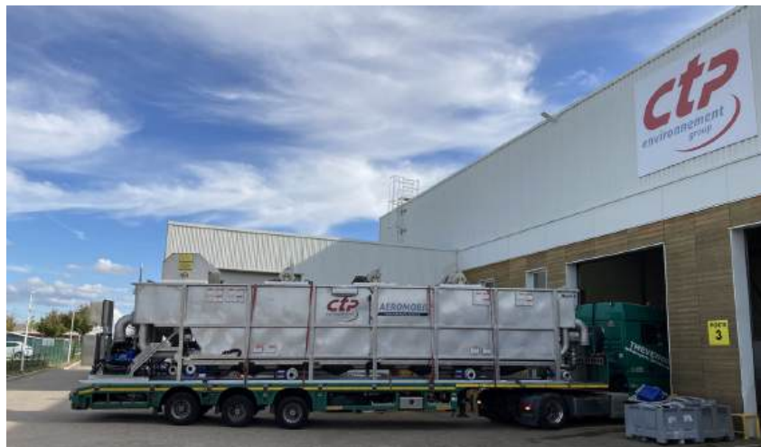
Ce flottateur d'unité mobile de CTP environnement assure le traitement physico-chimique et l'aéroflottation jusqu'à un débit de 1000 m 3 /h.
