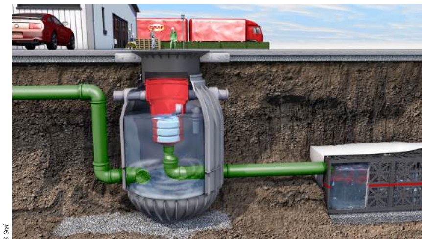
La dernière innovation en date de Graf est le regard épuratoire EcoPure 200, avec média filtrant PureSorp et d'un volume de 1 200 l.
