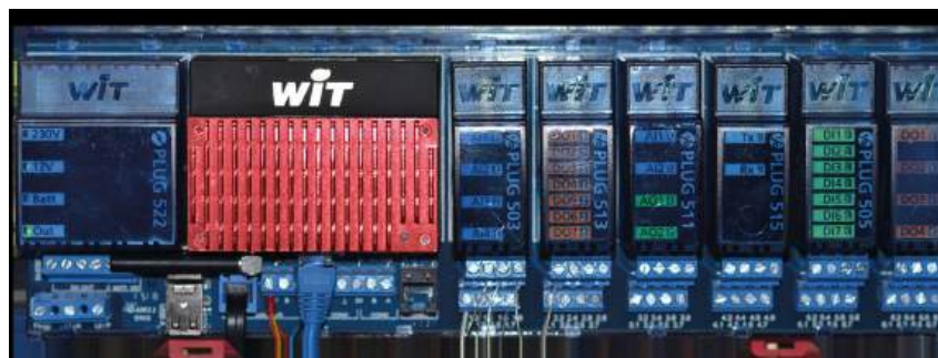
WITT a récemment intégré dans son unité locale « intelligente » REDY un composant de sécurité (Trusted Platform Module, ou TPM) directement au cœur de l'architecture.
