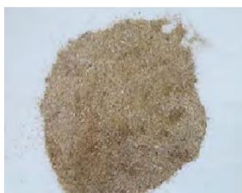
Figure 1: Sable de taille granulométrique 100  $\mu m$  utilisé dans nos expériences de filtration.
