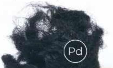
Afin de répondre aux enjeux d'élimination des micropolluants, Ajelis a développé une nouvelle génération de fibres catalytiques en palladium (Pd), référencée Chimicapt Pallada, pour affiner la suppression des
