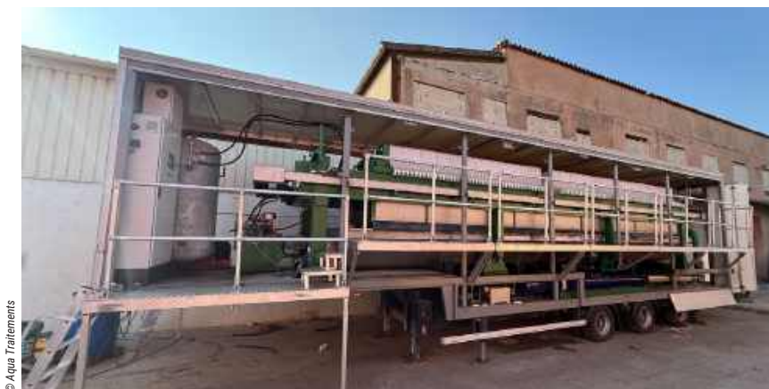
Le 10 e filtre-presses acquis par Aqua Traitements sera mobile, avec vis et tapis de convoyage des boues, deux pompes en parallèle de remplissage et d'une capacité de chambre de 6 m 3 .
