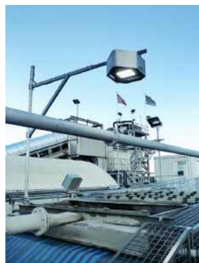
La solution RheoScan d'Andritz rend possible l'automatisation du réglage du dosage de polymères sur les tables d'égouttage gravitaires pour la phase d'épaississement.
