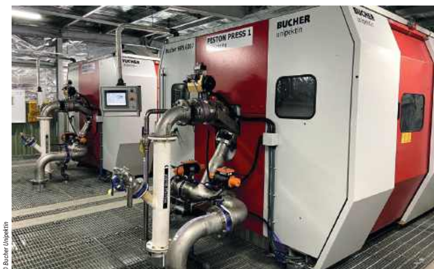
La presse à piston HPS de Bucher Unipektin fonctionne automatiquement et en continu. Elle accepte tous les conditionnements et est donc adaptée à tous types de valorisation de la boue.
